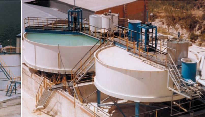
Espesado de caolín en tanques 10 m y 8 m Ø con sistema de elevación rastras
