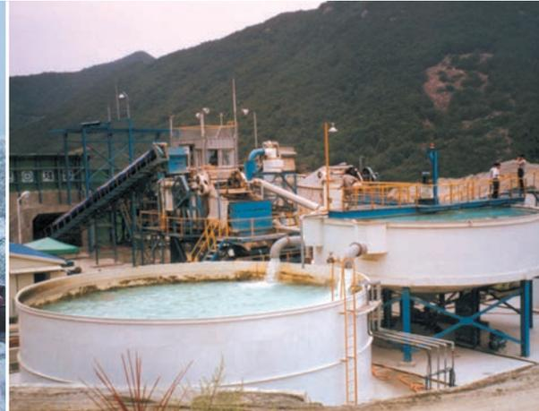
Clarificador 12 m Ø y agua clarificada en lavado de arenas
