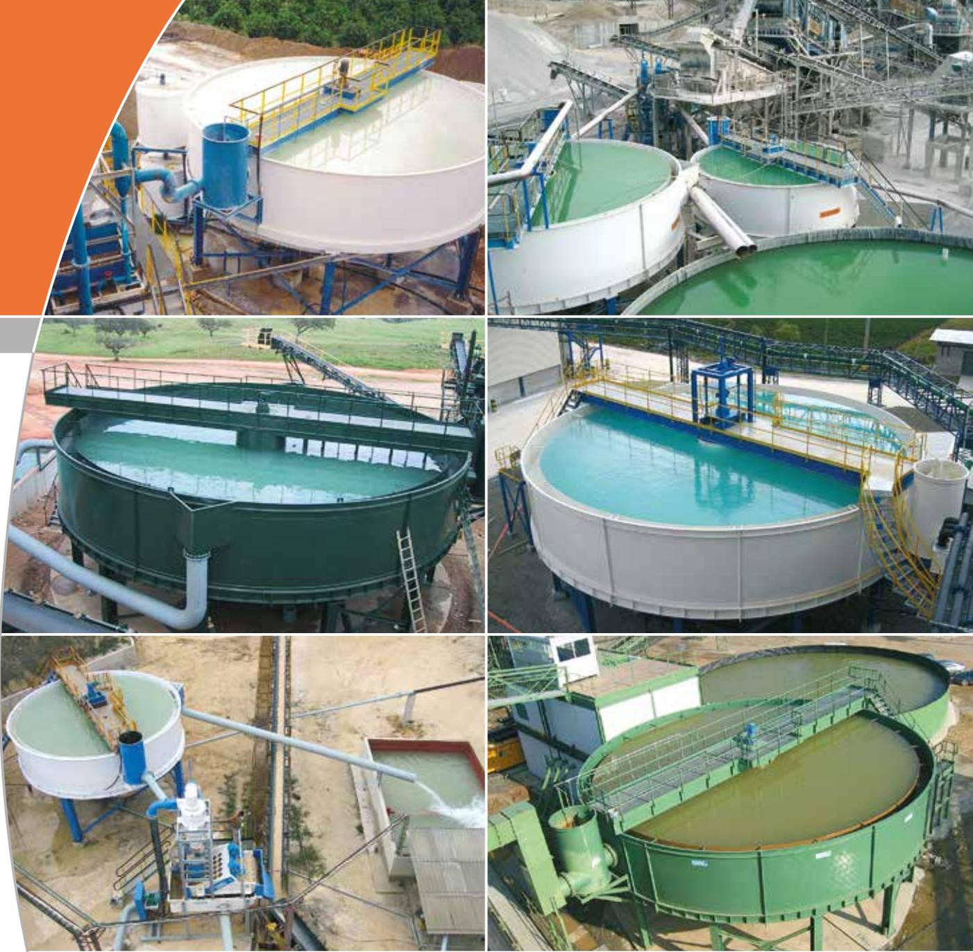
Los Clarificadores/Espesadores **ERAL** están especialmente indicados en el tratamiento de vertidos de efluentes, escorrentías y aguas residuales generadas en el lavado de áridos, arenas y minerales, así como en otros procesos productivos en las industrias de Aridos, Minería, Químico y Medio Ambiente.
